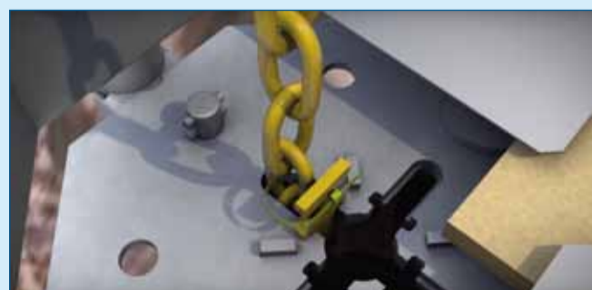
Figuur 3. De vloer hangt aan een kettingen, bijvoorbeeld aan de H-balken van het dak (3a). In de ronde koppeldelen van de vloer zijn sleuven aangebracht waar de ketting in verankert wordt (3b).
