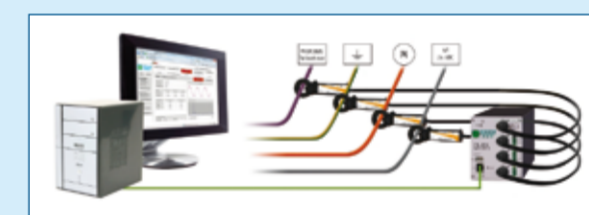
Figuur 4. Meetsysteem met meerdere breedbandige stroomtangen om de relatie tussen aardstromen te ontdekken.
