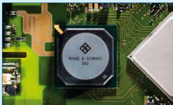
Afbeelding 3. De door R&S zelf ontwikkelde 10 bit ADC.
