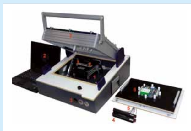
Figuur 1. Het totale teststelsel bestaat uit de volgende onderdelen: 1 - YAVPack, 2 - Computer met Master Script Edition software, 3 - MMI bedieningspaneel, 4 - VPC Connector interface met YAVPack, 5 - Patchords tussen de VPC connector en de testprobes, 6 - Customized Cassette voor iedere PCB die u met uw SmartFixture wilt testen, 7 - SmartFixture Basis fixture.
