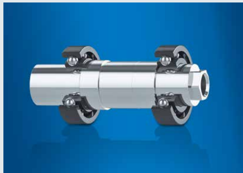
Afbeelding 2. De encoders zijn aan beide uiteinden van de encoderas voorzien van een lager en zijn daardoor goed bestand zijn tegen axiale en radiale krachten.
