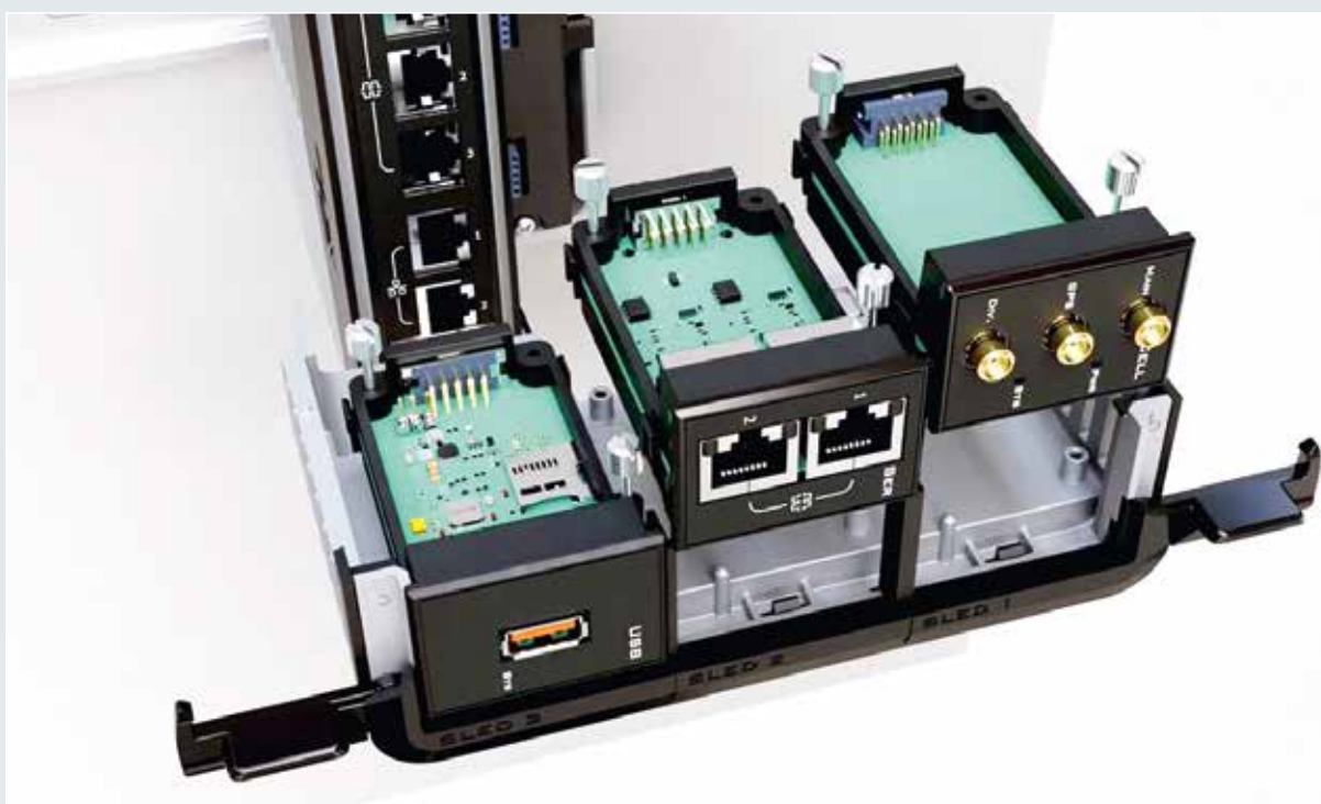
Afbeelding 2. Er kunnen afhankelijk van de wens drie communicatiemodules opgenomen worden.
