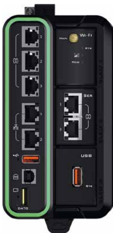
Afbeelding 1. Doordat de DA70D kan praten via 300 verschillende protocollen, geldt bijna de kreet 'alles in en alles uit'.
